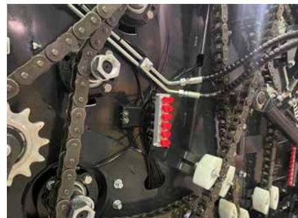
Graissage centralisé pour les roulements de la chambre.
