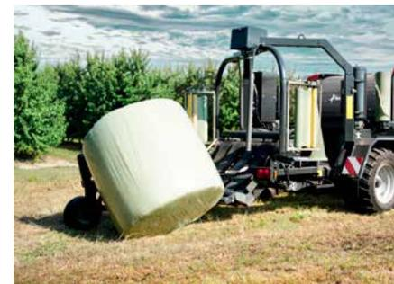
Option de vire balle. Pendant le transport, il est automatiquement déplacé en position route sous l'enrubanneuse.
