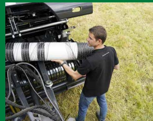
La hauteur de chargement très basse et la simplicité d'enfilage du système permettent de réduire au minimum les temps d'arrêt et d'optimiser le temps de pressage.
