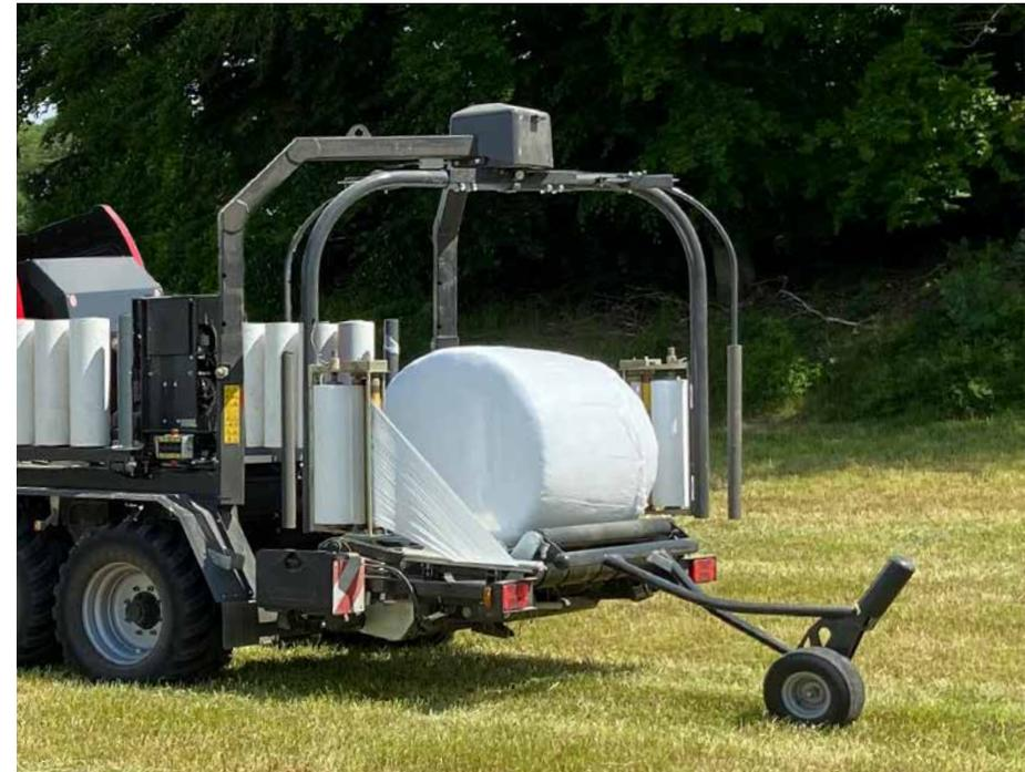
Enrubanneuse double satellite munie de deux pré-étireurs et de quatre courroies sans fin pour un enrubannage rapide et régulier.
