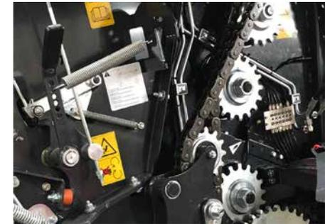
Des chaînes 1¼" de type HBC sont utilisées pour l'entraînement de la chambre de pressage et du rotor.
