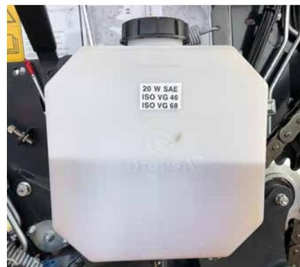
Réservoir de lubrification des chaînes grande capacité.
