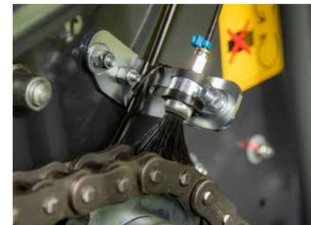
La lubrification automatique des chaînes est incluse en standard.
