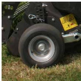
Roues de jauge avec réglage simple de la hauteur de ramassage.
